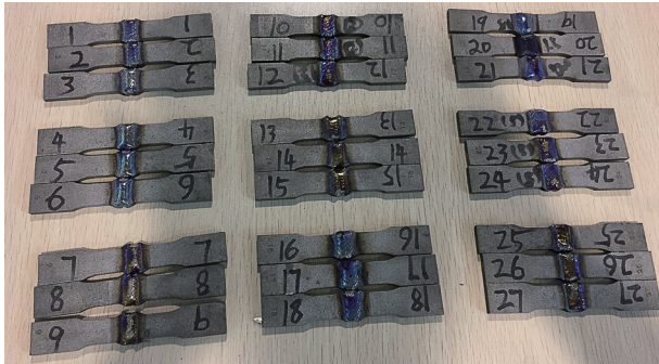
(b) 激光成形连接后试验件
